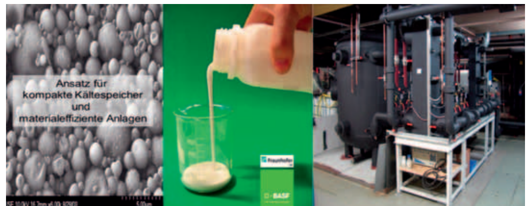
Bild 3: Mikroverkapseltes Paraffin, Phase-Change-Slurry und Versuchsanlage im Imtech-Labor in Hamburg.
