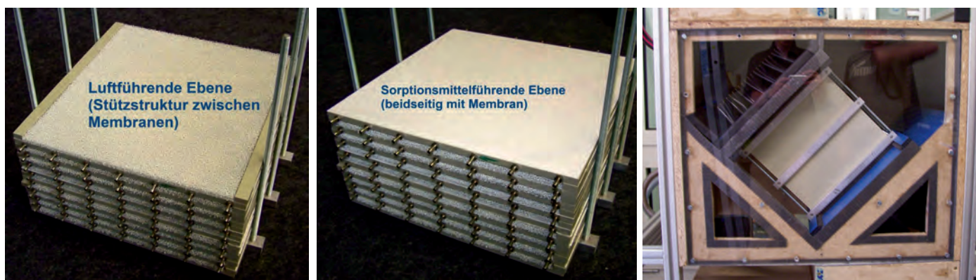
Bild 2: Prototyp eines Membran- Wärmeübertragers zur kondensatfreien Luftkühlung und -entfeuchtung; aktive Membranfläche 2,1 m 2 .
