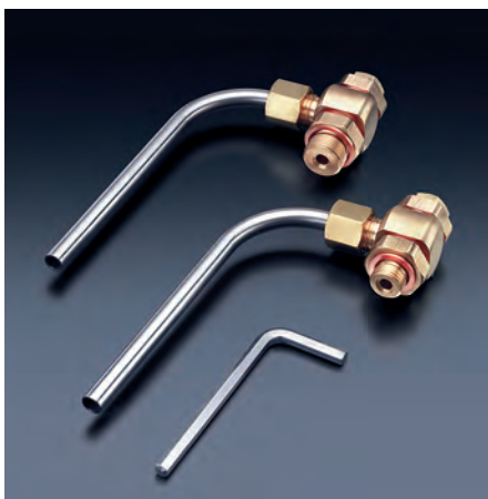
Abb. 1 „Aquaström P“ beflammbares Probenahmeventil für hygienisch-mikrobiologische Untersuchungen gem. DVGW W551, TrinkwV und VDI 6023.
