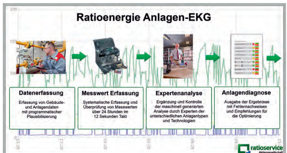
Bild 5: Verfahrensablauf des Mess- und Analyseprozesses.
