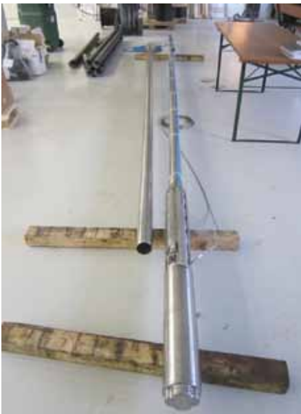
Abbildung 5: 4" - Unterwasserpumpe vor dem Einbau.
