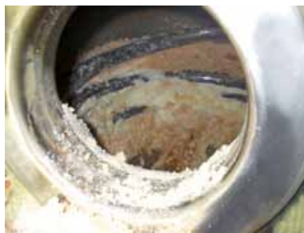
Bild 1: Stark verkalkte Warmwasserbereiter sind unappetitlich und gefährlich, weil sie das Wachstum von Mikroorganismen begünstigen.
