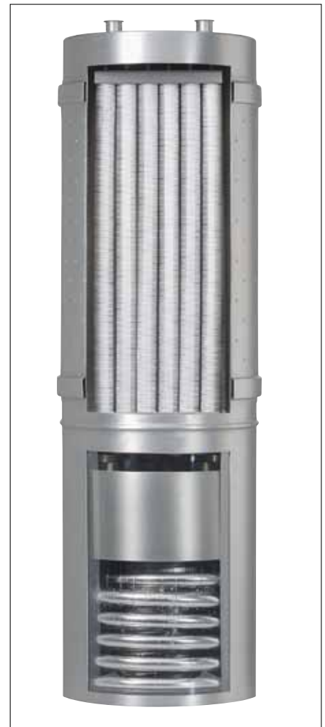
Bild 3: Das Wärmepumpenmodul der Vitosorp 200-F nutzt kein synthetisches Kältemittel, sondern natürliches Wasser; der obere Bereich zeigt den mit Zeolith beschichteten Wärmetauscher.
