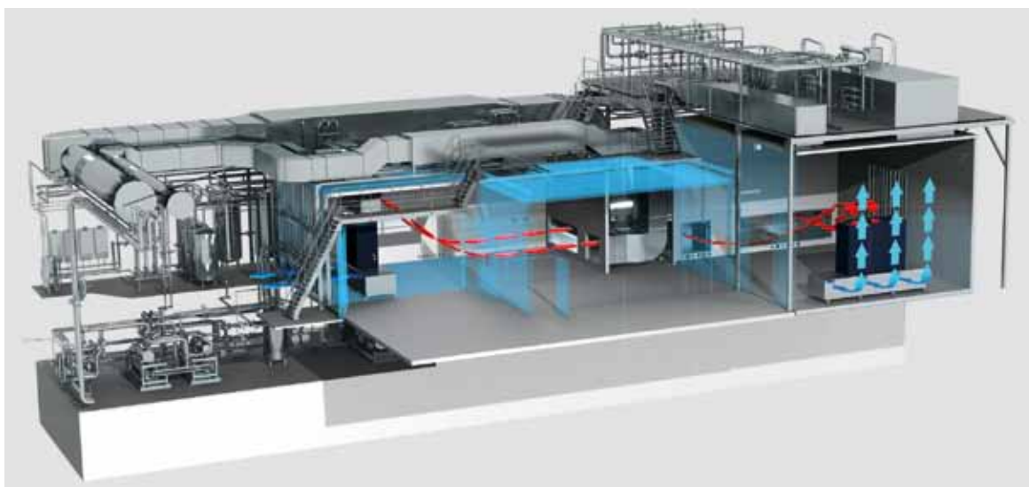
Abb. 1: Auf rund 700 qm Fläche betreibt Stulz eine der modernsten Prüfeinrichtungen für Klimatechnik in Europa. Die Anlage bietet zwei separate Klimakammern und vier Konditionierungsanlagen.
