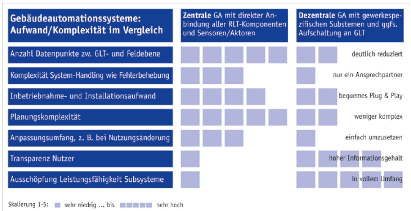
Abbildung 3: Zentrale und dezentrale GA-Systeme im Vergleich.
