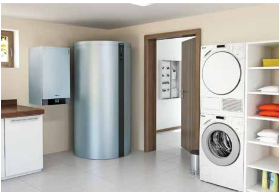
Abbildung 6: Mikro-KWK-Gerät Vitovalor 300-W mit Stirling-Motor und integriertem Gas-Brennwert-Spitzenlastkessel, daneben der Heizwasser-Pufferspeicher Vitovalor 300-W
