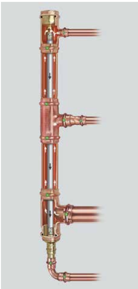
Grafik 1: Funktionsweise der Inliner-Technik: Über das Anschlussset (unten) gelangt das Warmwasser in den Steigestrang, wird am Ende in das innen liegende PB-Rohr umgelenkt und zurück zum Warmwassererzeuger bzw. -speicher geführt. Grafik: Viega
