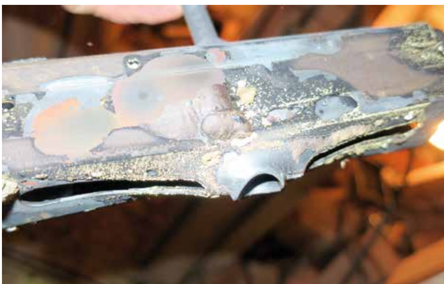
Abbildung 4: Deformierte Rückenlochung einer Montageschiene nach Brandversuch
