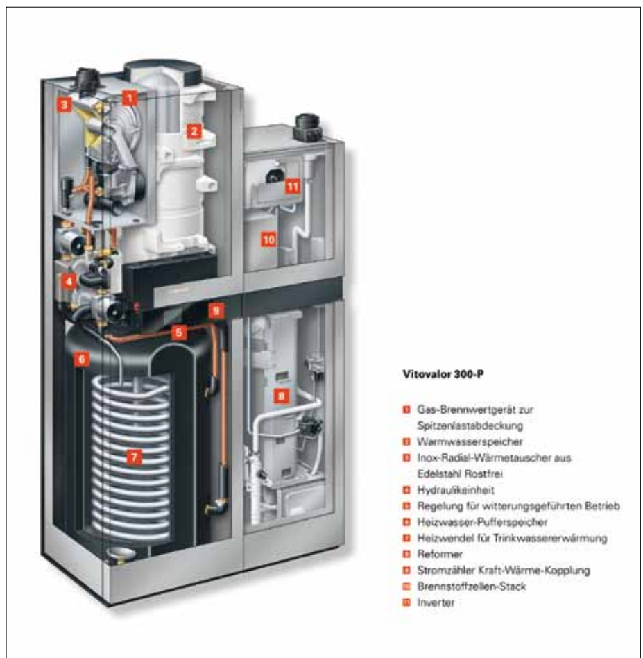
Abbildung 3: Brennstoffzellen-Heizgerät im Schnitt: Brennstoffzellen- und Spitzenlastmodul beanspruchen zusammen eine Aufstellfläche von lediglich 0,65 Quadratmetern. Grafik: Viessmann
