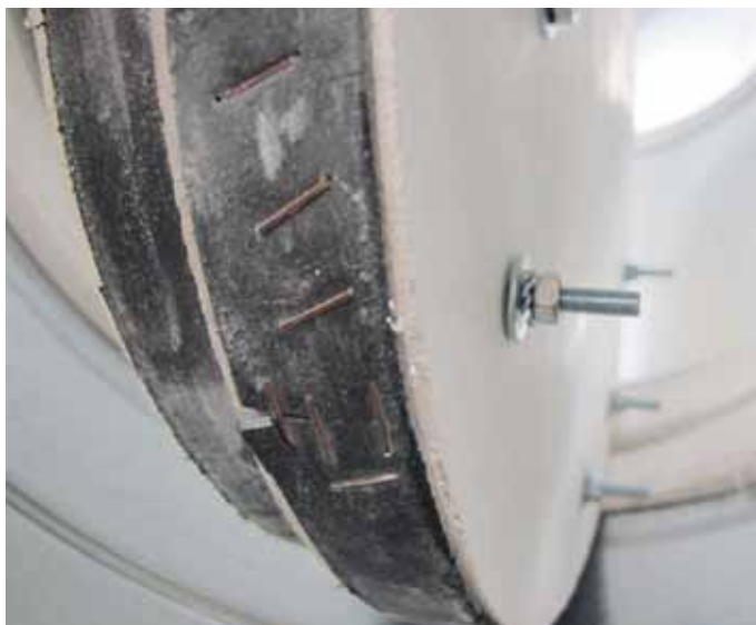
Abbildung 4: Herausstehende Schrauben am Klappenblatt eines Vergleichsproduktes Foto: TROX
