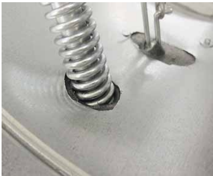
Abbildung 5: Scharfe und krumme Blechkanten eines Vergleichsproduktes Foto: TROX
