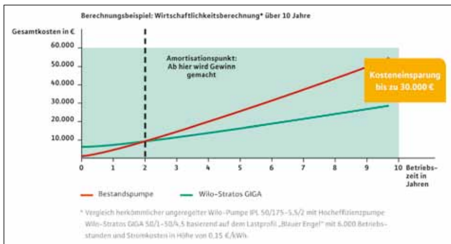
Bild 4: Im Vergleich zu unregulierten Pumpen können Energiesparkosten von bis zu 30.000 Euro mit hocheffizienten Modellen wie der Wilo-Stratos GIGA eingespart werden.
