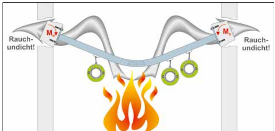
Abbildung 5: Rauchundichtigkeit an Wandbefestigungen ausschließen
