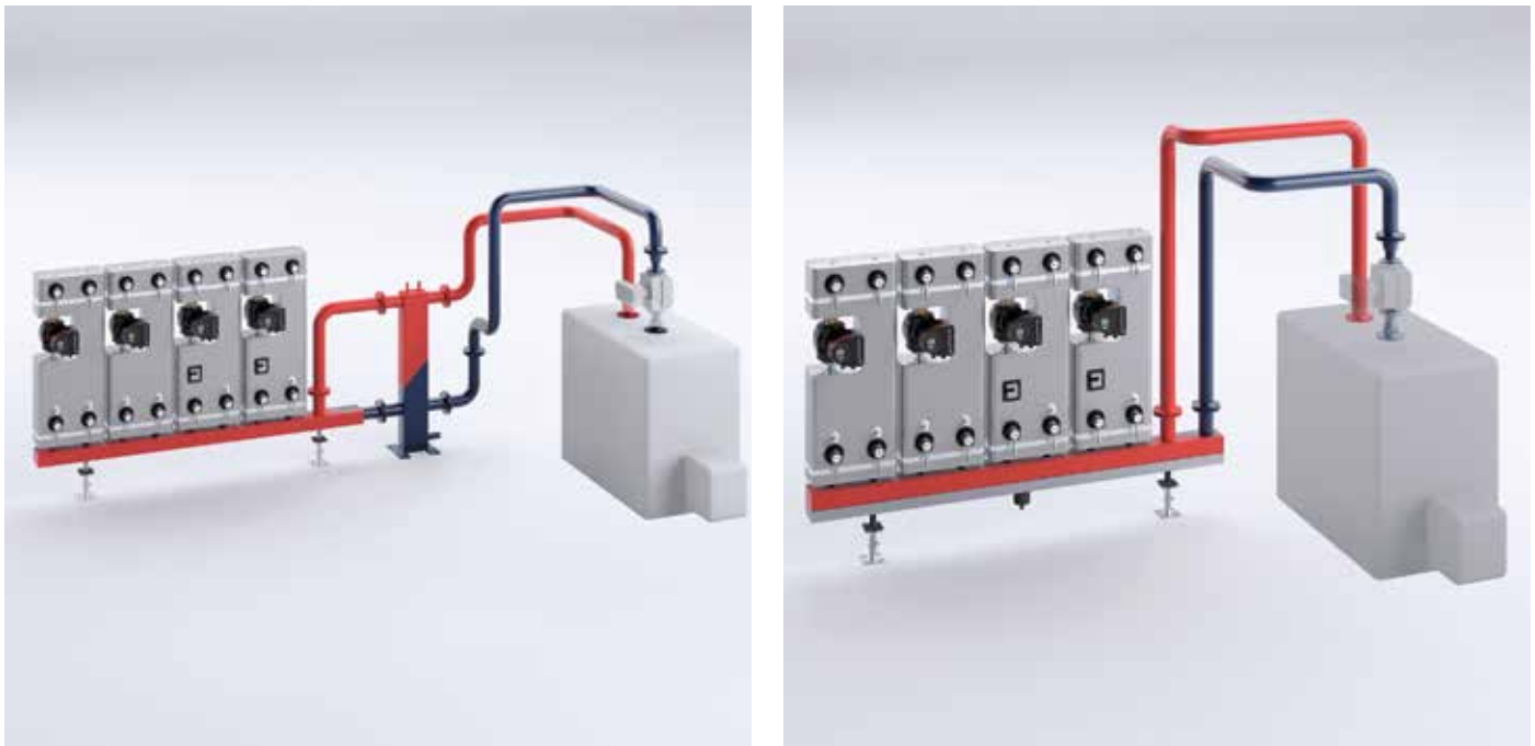
Abbildung 2: Klassische hydraulische Weiche im Vergleich mit einem Sinus HydroFixx
