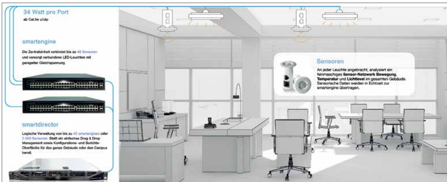
Abbildung 2: Aufbau und Funktion der smartengine-Technologie
